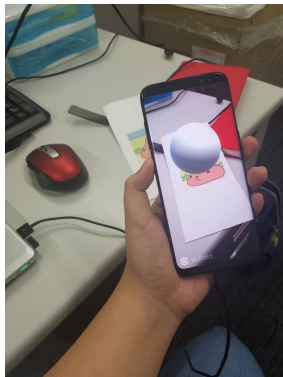
図 8 : スマホで実装したマーカー型 AR MOVERIO でも同様の AR を実装することができた.
