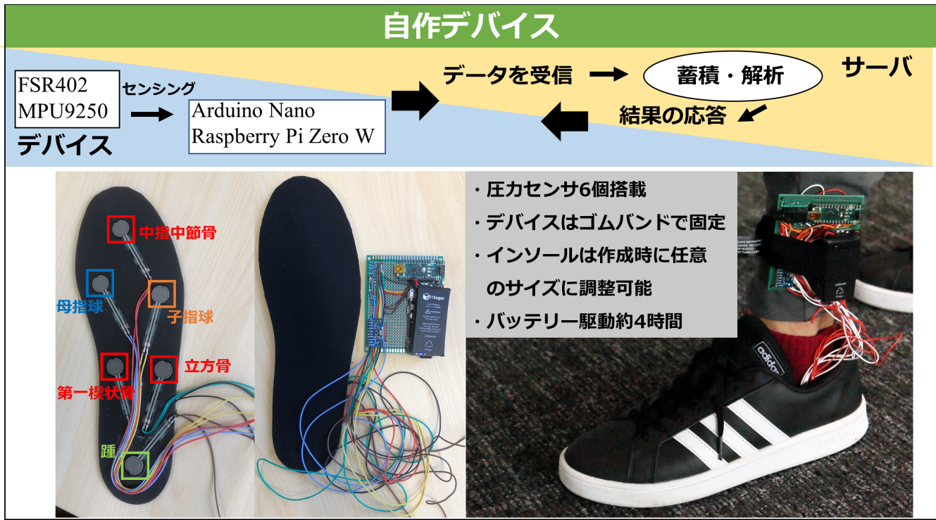
図5 自作デバイスの概要
