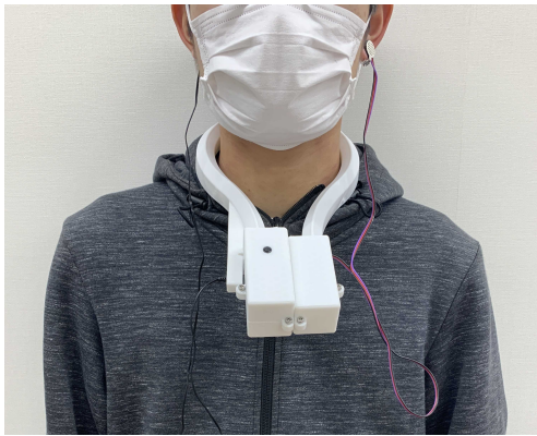
図 4.3: 先行研究のネックバンド型機器の装着方法 図 4.4: 本研究のネックバンド型機器の装着方法
