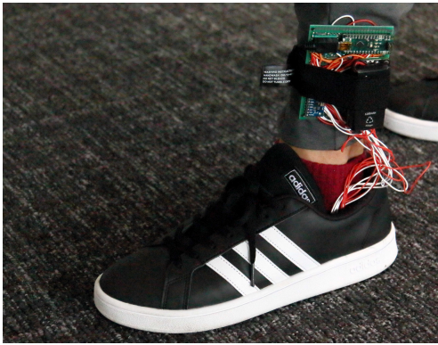
図 4.1: 先行研究のインソール型機器の装着方法
