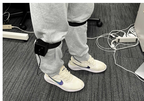
図 4.2: 本研究のインソール型機器の装着方法
