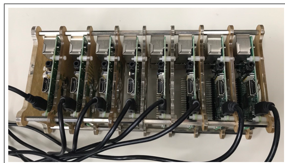
図 3.7: 実験に用いるラズベリーパイ 8 台
