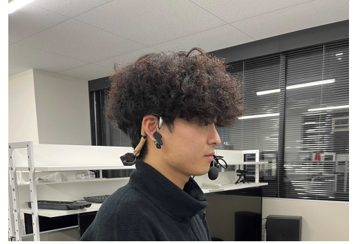
図 4.4: 本研究のネックバンド型機器の装着方法
